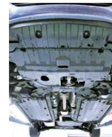
Spodek vozidla i30 je velkoplošně obloženo. To šetří palivo a chrání motor a převodovku před nečistotami.
