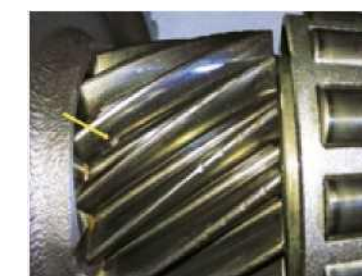
U hnacího kola hřídele pohonu je na bocích dvou zubů lehké vyštípnutí.
