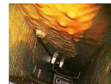
Vydatná ochrana proti korozi. Konzervace dutin je dostačující, ale zčásti nanesená viditelně nerovnoměrně.
