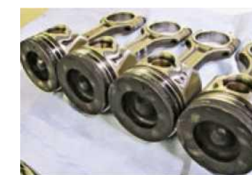
Všechny písty jsou po proměření ještě v rozsahu tolerance nových dílů.
